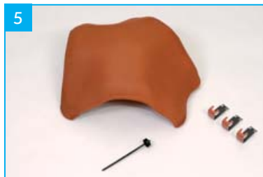
Rozdělovací hřebenáč drážkový HO s třemi příchytkami hřebenáče HO+N a s jedním vrutem Pro napojení hřebene a dvou nároží. Pro sklony střech 15° až 55°. Přípevnění: 3 příchytky HO+N se 3 vruty 4x66 mm nebo jeden utěšňovací vrut.
