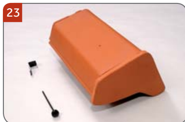
23 Univerzální pultový hřebenáč začáteční, pravý s jednou příchytkou hřebenáče HO + N a s jedním vrutem Pro napojení pultové hrany na štítovou.
