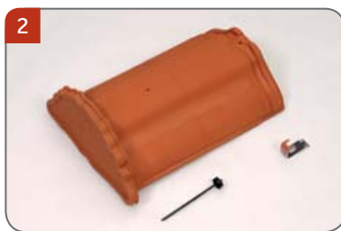
2 Hřebenáč začáteční drážkový HO s jednou příchytkou hřebenáče HO + N a s jedním vrutem Pro začátek hřebene, nároží a konec hřebene.
