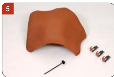
5 Rozdělovací hřebenáč drážkový HO s třemi příchytkami hřebenáče HO+N a s jedním vrutem Pro napojení hřebene a dvou nároží. Pro sklony střech 15° až 55°. Přípevnění: 3 příchytky HO+N se 3 vruty 4x66 mm nebo jeden utěšňovací vrut.
