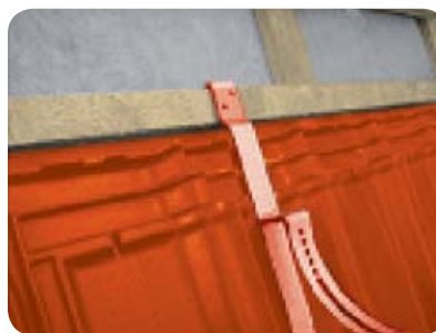
Obr. 9 Připevnění závěsného háku
