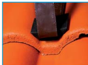
Obr. 2 - Nasazení pryžové podložky u ŘT
