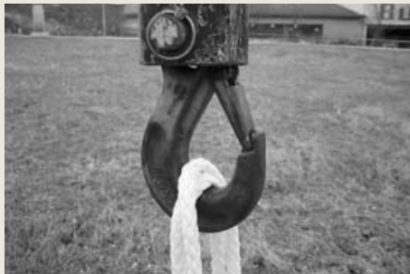
Zvedací lano zavěsit na hák jeřábu
